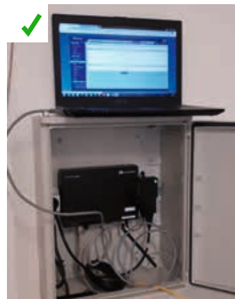
Interface de pilotage du couple production PV-demande de froid permettant de gérer au mieux la production et la consommation et d'affiner la régulation. ©AQC
