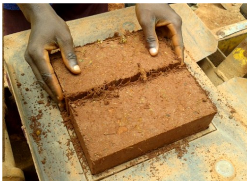
Brique stabilisée avec des fibres naturelles - source : makery.info
