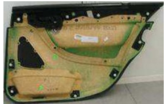
Exemple d'utilisation de biocomposite : Intérieur de porte de la Peugeot 607 composée à 70% de fibres de bois et 30% de résine acrylique, Source : étude des scénarios de fin de vie des biocomposites, Université Montpellier 2, 2014
