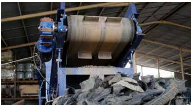
→ Unité de broyage des pneus, Rémire Montjoly, CSR.
