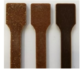
Eprouvettes biocomposites intégrant des fibres d'ananas et de bananier, Projet GUYAVALOFIBRES, 2018-2019
