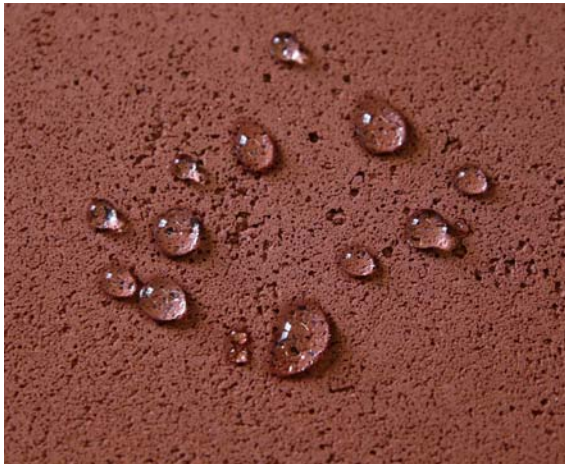
Gouttes d'eau sur un enduit de terre rouge de Royan avec du blanc d'œuf © Aurélie Vissac/CRAterre-ENSAG
