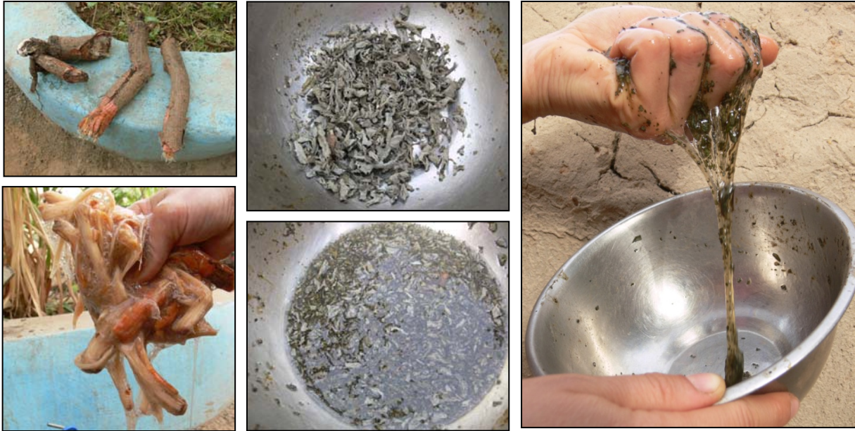
A gauche: morceaux de liane « vounou » avant et après avoir été écrasés et trempés dans l'eau, donne le gluant. Au centre : des feuilles sèche « fouga » puis trempées dans l'eau. A droite : ces même feuilles donne une eau très gluante. Burkina Faso © Laetitia Fontaine/CRAterre-ENSAG
