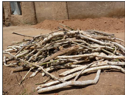
Banches de hilampo , quantité nécessaire pour les 2000 L de mixture. © Sébastien Moriset/CRAtterre-ENSAG
