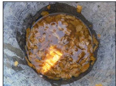
Papier avant transformation utilisé dans un enduit © Laetitia Fontaine/ CRAterre-ENSAG
